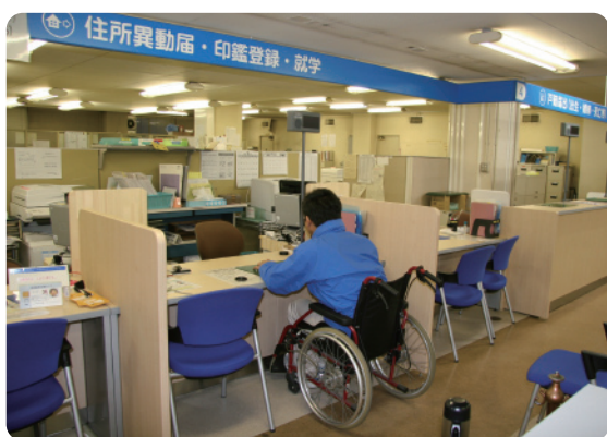
車いすに配慮した受付カウンター
