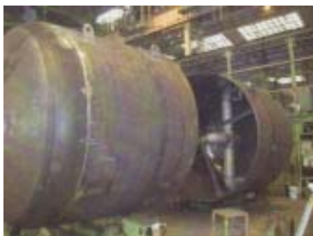
鋼製貯水槽の工場製作状況
