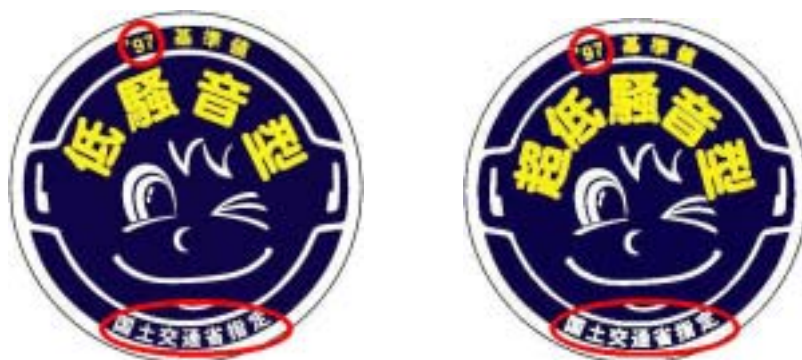
新基準適合機械の低騒音型機械・超低騒音型機械のステッカー
