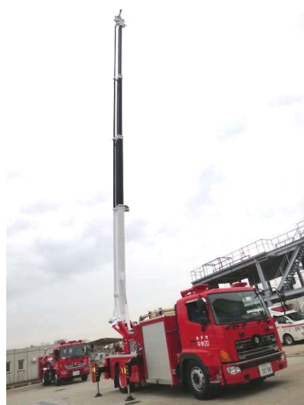
原液搬送車（奥）大型化学高所放水車（手前）
