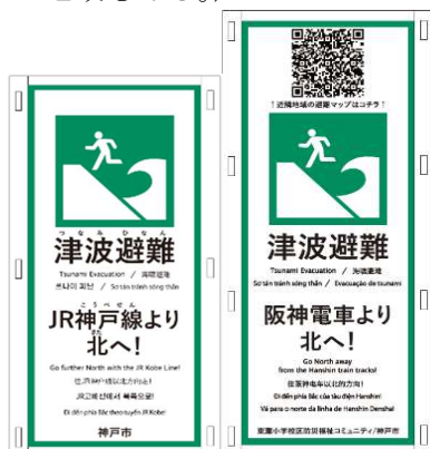
図 5-1-2 津波表示板 (誘導表示)
